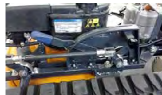
Regolazione dell'altezza di taglio con posizione flottante integrata e la posizione di copertura regolabile.
