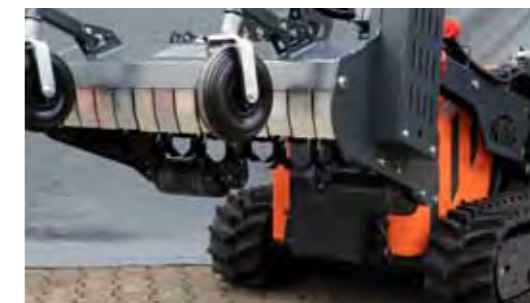
Grazie all'ampio movimento del sollevatore, l'angolo di inclinazione è massima; per un facile inserimento nei pendii o nei fossi.
