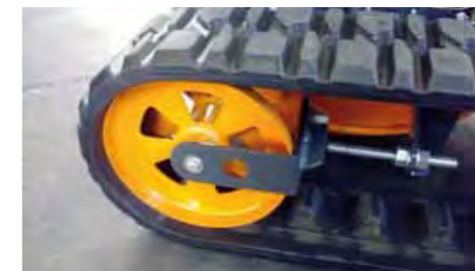
Ruote motrici e ruote iClick in versione professionale con supporti di grandi dimensioni e raschietti.
